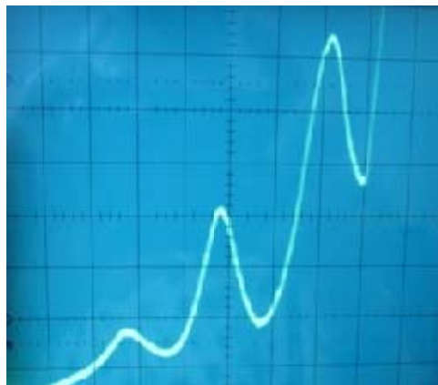
Рис. 4. Вид вольт-амперной характеристика на экране осциллографа
