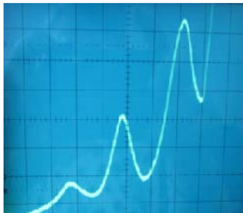
Рис. 4. Вид вольт-амперной характеристика на экране осциллографа
