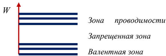
Рис. 1. Зонная структура полупроводников
